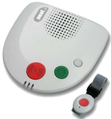
Freisprechverbindung in die Hausnotruf-Zentrale
